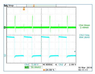
圖 50 顯示的是對實際的 lext\_boot 進行測量的結果, 2.49mA 的資料很接近模擬分析的結果。
