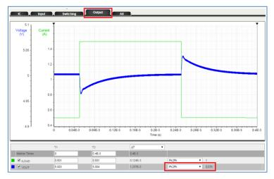
由於開關切換工作頻率很高,1A 快速負載跳變所導致的電壓下墜的幅度大約為 40mV,小於輸出電壓的 1%;輸出電壓的紋波也很小,大約為 4mV。負載跳變所導致的回應過程是穩定的,這說明系統具有足夠的相位裕量。
