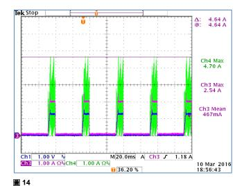
圖 14 顯示的是 RT2875BQ 在 28V 輸入電壓下發生持續超載情況下的波形:當電流限制發生以後,輸出電壓降低,當它降低到設定輸出電壓的 50%時就觸發了欠壓保護,輸出被關閉。
