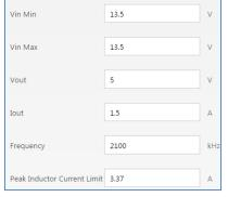
為了讓電路在計算出的電流限制值下進行模擬,我們在圖 8 所示的功能表中鍵入 3.37A 的峰值電感電流限制值。
