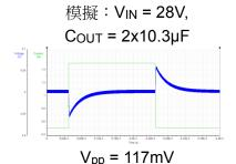
實際量測:208mVpp(已因觸及 最短導通時間而行脈衝跨越)
